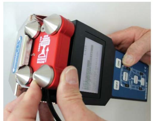
Fahrwerkvermessung kann so einfach sein: Der Neigungsmesser CM 09606 ist enorm praktisch.
