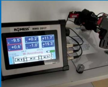
Rief bei der Automechanik sehr großes Interesse hervor: das Gelenkwellenknickwinkel-Messgerät RMG 2017.
