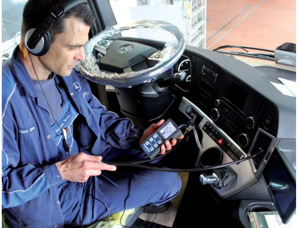
ROMESS'in ultra sesli sızıntı bulucusu USM 20128 en ufak sızıntıları dahil tespit edebiliyor. Bu ticari araçlarda hem zamandan hem de paradan tasarruf sağlıyor. Tamirhaneler cihazı ücretsiz deneyebilirler. Taleplerinizi için: info@romess.de .
