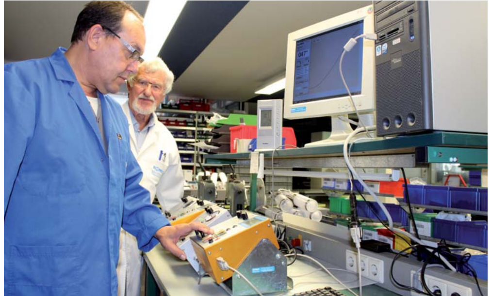
Damit sie zuverlässig und hoch präzise funktionieren, werden die Bremsflüssigkeitstestgeräte der Modellreihe Aqua in der Produktion sorgsam justiert.
